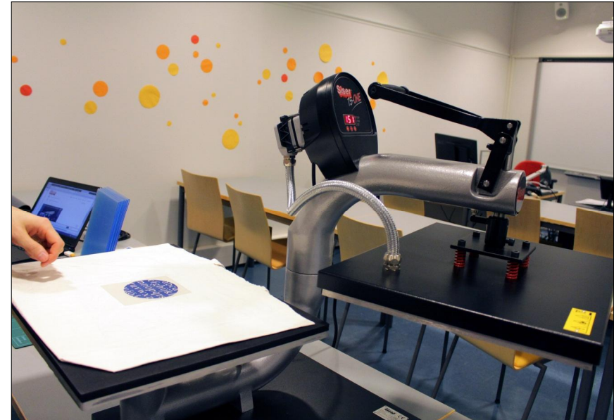
KUVA 5. Kun prässä 15 sekunnin jälkeen hälyttää, nosta kahva ylös ja käännä painolevy oikealle.
