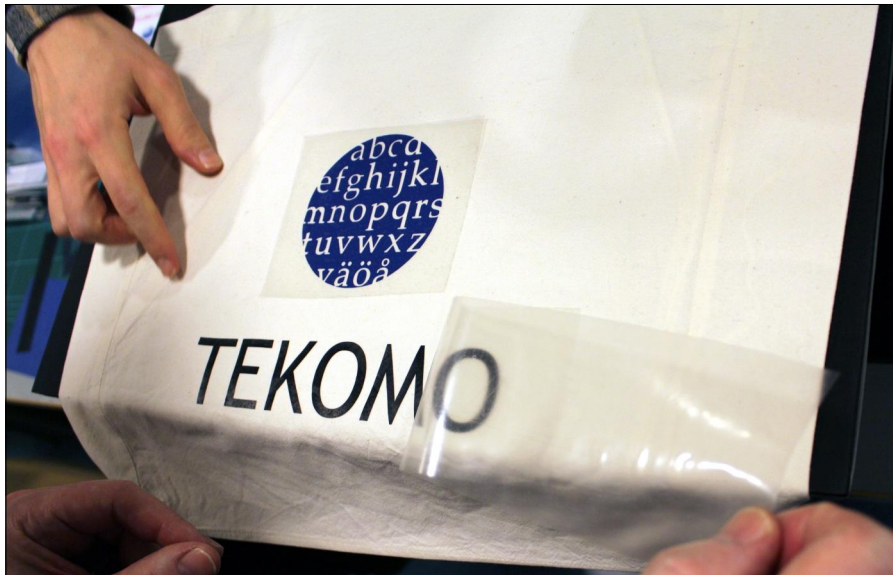
KUVA 7. Kaksi ei-päällekkäistä kuviota voidaan painaa yhtä aikaa.
