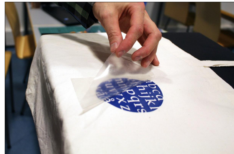
KUVA 6. Kalvo irrotetaan tekstiilistä, ja kuvio jää kankaaseen.
