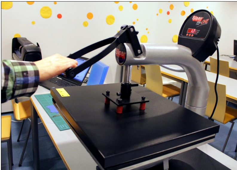
KUVA 4. Kahva loksahdaa pohjaan ja sekuntilaskuri käynnistyy.
